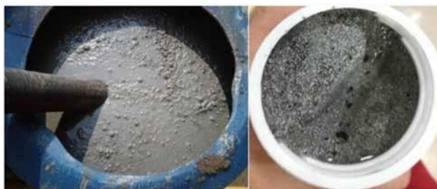
Abbildung 3: Bei der Spülung des Desanders im August 2018 wurde eine beträchtliche Menge Sand mit Stützmitteln (2 Fässer) gesammelt.
