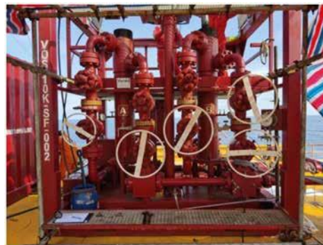
Abbildung 4: Der Sandfilter mit zwei Töpfen wurde mobilisiert und mit Hilfe von temporären Rohrleitungen als Teil des temporären Oberflächen-Sicherungspakets während des anfänglichen Bohrloch-Flusses an der Flussleitung angeschlossen.
